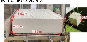
約200万個のシンチレータキューブからなる新検出器Super-FGD
