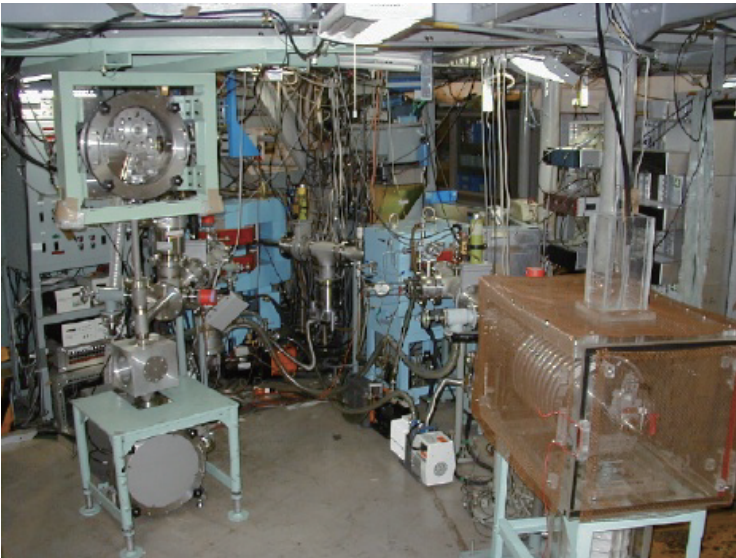
核ビームを作り出すオンライン同位体分離装置(KUR-ISOL)
