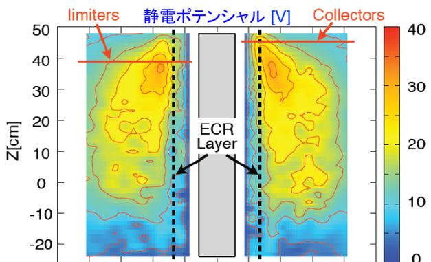
単純なトロイダル磁場中に、1kWレベルのマイクロ波を入射すると、電子サイクロトロン共鳴層近傍に縦に伸びたプラズマが生成・維持されます。このとき、プラズマ中には左図に示すような静電ポテンシャルが自発的に形成され、電子とイオンの流れを自己調節することで、プラズマが維持されます。
