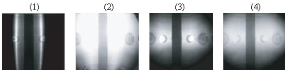
(1) → (2) → (3) → (4) と時間がたつにつれ、縦長だったプラズマがドーナツ状になり、更に球のようになっていくのがわかる。これはプラズマ中に電流が発生し自分自身で磁場形状を変えてゆくためである。プラズマ電流が 4 kA の時の磁力線は右図のように捩じれて典型的な球状トカマク配位になっている。
