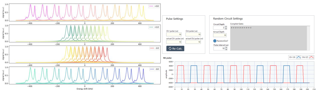
Fig.1 (a) z 軸方向のバイアス磁場が 2G のときの 7 \times 7 が 10 層な原子アレイの各 mF のゼーマンシフト分布. (b) クリフォードゲートを X(\pi/2) , Z(\pi/2) ゲートに変換した場合のパルス波形を示す実際の vi の様子. 赤が Z ゲート, 青が X ゲートのパルス.
