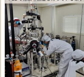
パルスレーザー蒸着の様子、光って見えるのはプラズマ化した蒸発粒子
