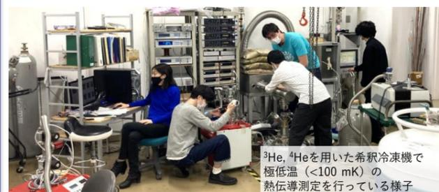
$^3\text{He}$ 、 $^4\text{He}$ を用いた希釈冷凍機で極低温 (<100 mK) の熱伝導測定を行っている様子
