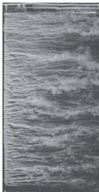
右の写真は、実験室内で行われた流体物理の実験の写真です。流れは写真の左から右にむかっています (写真は流路を上から撮影したものです)。可視化のためにいれた煙によって壁面近傍の乱流の構造が浮びあがっています。ここでも下流に伸びている筋が認められます。
